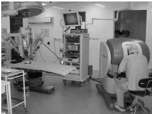
Рис. 1. Общий вид роботизированного хирургического комплекса: операционная консоль с манипуляторами, лапароскопическая стойка, консоль хирурга (тренировка операционной бригады)
