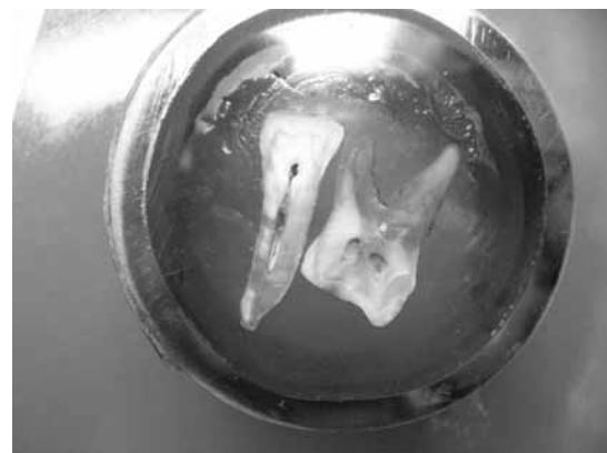
Fig. 1 Aspectul dinților secționați înglobați în rășină epoxidică
